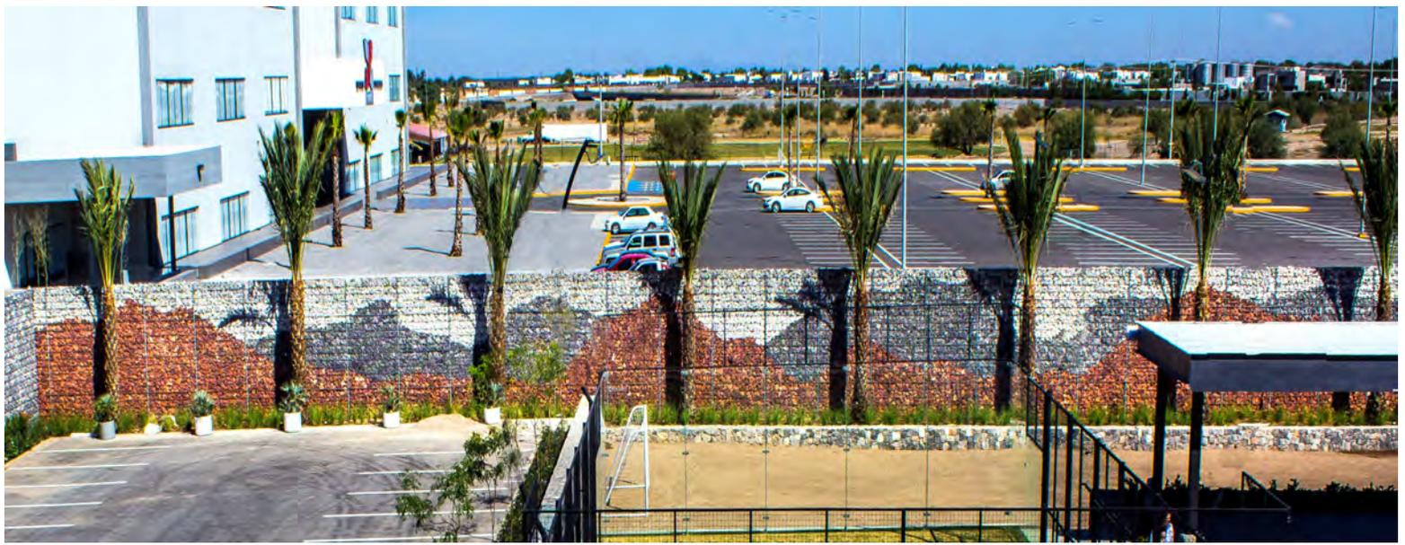
La nueva barda gavión encuentra absoluta armonía con el entorno natural, dándole distinción e innovación a sus proyectos, desplazando a las bardas perimetrales de block, cemento y varilla.
